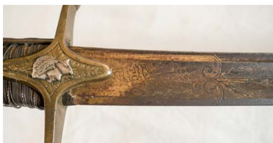
Obr. 108/Obr. 109 Důstojnická šavle Grenadiere (Císařská garda), 1809, Francie – Paříž, soukromá sbírka. Ukázka devastace způsobená podreznutím základního materiálu čepule s oceli na povrchovou úpravu ze zlacení a modření. Postupující koroze degraduje nejen samotný základní materiál z oceli, ale i povrchovou úpravu šavle, vytvořenou metodou chemického zlacení a modření. Zlato se jeho působením postupně ze základního materiálu odlupuje.
