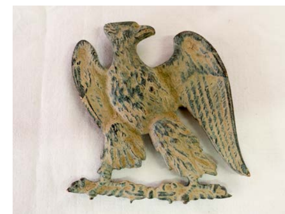
Obr. 99 Bronzový odlitek orla určený na čelní stranu husarské brašny, Francie, kolem roku 1800, soukromá sbírka. Ukázka degradace povrchu materiálu působením sirmých složek v půdě.
