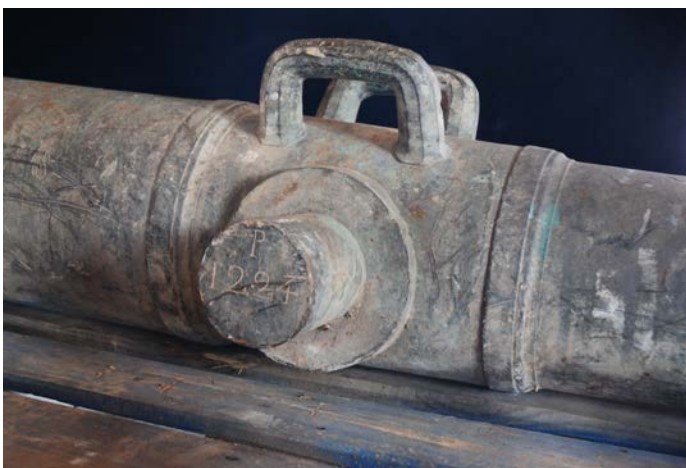
Obr. 97 Dělo 8-liberní, konec 18. stol., Francie, soukromá sbírka. Odlitek z bronzové děloviny. Půdní nález vykazuje v detailu narušení povrchové vrstvy (tzv. nemoc bronzu – modrozelenou vrstvu korozních produktů tvoří většinou zásadité uhličitany).
