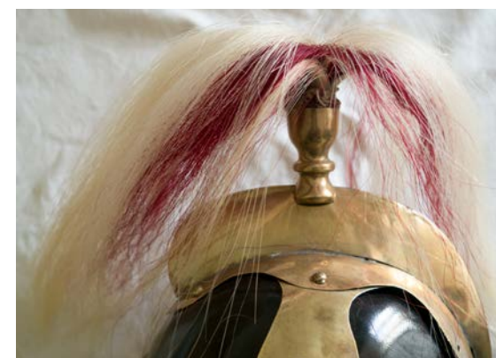
Obr. 119 Důstojnická hasičská přilba, konec 19. stol., Rakousko, soukromá sbírka. Ukázka degradace výzdoby z koňských žíní, způsobovaná ztrátou vnitřní mastnoty tohoto materiálu. Ta je zapříčiněna buď samovolným postupným vysycháním, nebo po napadení roztoči. V obou případech dochází k narušení vnitřní struktury materiálu, jejímu rozpadu a lámání.
