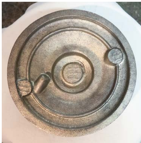
Obr. 18 Elektronový odlitek náboje předního kola motocyklu Norton, okolo 1935, soukromá sbírka.
