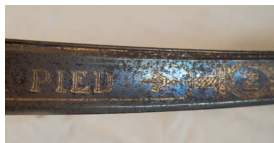
Obr. 108/Obr. 109 Důstojnická šavle Grenadiere (Císařská garda), 1809, Francie – Paříž, soukromá sbírka. Ukázka devastace způsobená podreznutím základního materiálu čepule s oceli na povrchovou úpravu ze zlacení a modření. Postupující koroze degraduje nejen samotný základní materiál z oceli, ale i povrchovou úpravu šavle, vytvořenou metodou chemického zlacení a modření. Zlato se jeho působením postupně ze základního materiálu odlupuje.
