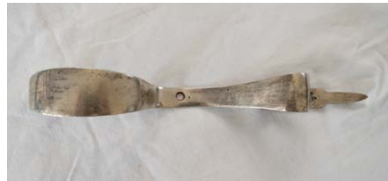
Obr. 11 Lučik pušky (perkusní kulovnička), pol. 19. stol., střední Evropa, soukromá sbírka. Materiál z alpaky je obvykle zbarven bílo-žlutě, na snímku je zřejmá povrchová degradace tohoto kovu (tmavé skvrny) působené působením siričných par obsažených v ovzduší.
