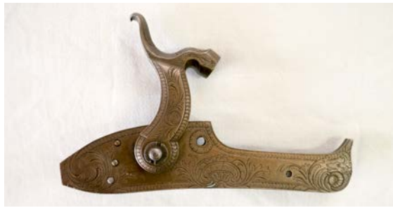
Obr. 10 Perkusní zámek k brokovnici, 1. pol. 18. stol., Čechy – Praha (A. V. Lebeda), soukromá sbírka. Zámek povrchově upraven chemickým niklem jako součást dobových prostředků v ochraně proti korozi.
