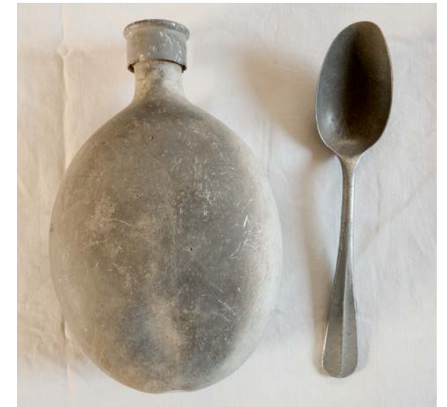
Obr. 17 Hliníková láhev (čutora) na vodu, II. světová válka, Německo (zn. W.A.L. 39), soukromá sbírka. Povrch jeví známky napadení kovu korozí způsobenou přítomností chloridů a síranů (půdní nález), který tento způsob degradace hliníku výrazně urychluje.
