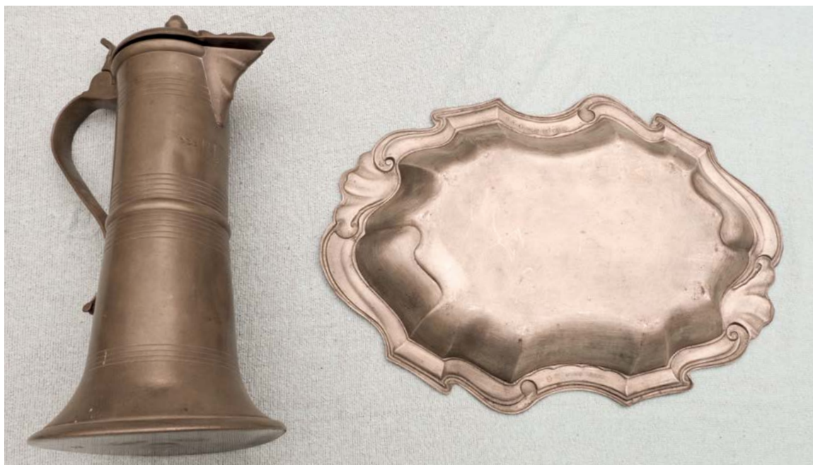
Obr. 100 Cínové nádoby, (korbel) pol. 18. stol. a (podnos) 3. třetina 18. stol., střední Evropa, soukromá sbírka. Snímek dokládá vizuální rozdíl mezi vyčištěnou plochou cínového podnosu a cínového povrchu s patinou (způsobena působením vodní vlhkosti a chloridů v běžném klimatu). Korozí podporuje ve slitině cínu obsažená příměs olova.
