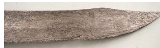
Obr. 91 Lovecký tesák, přelom 17. a 18. stol., Německo, soukromá sbírka. Ukázka devastace povrchu čepele rzí, jejíž podoba přecházející z důlkové koroze do hlubokých kavern, se objevila po nevhodné aplikaci směsi kyseliny fosforečné, použité pro její odstranění. Směs kyseliny současně způsobila i devastaci struktury hmoty kovu.
