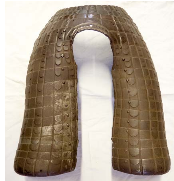
Obr. 89 Spodní část zbroje (kovové kalhoty tzv. šorce) pěšího lanknehta, 1. čtvrtina 16. stol., Německo, soukromá sbírka. Ukázka povrchová koroze způsobené dlouhodobým uložením v neregulované vlhkostí ovzduší.
