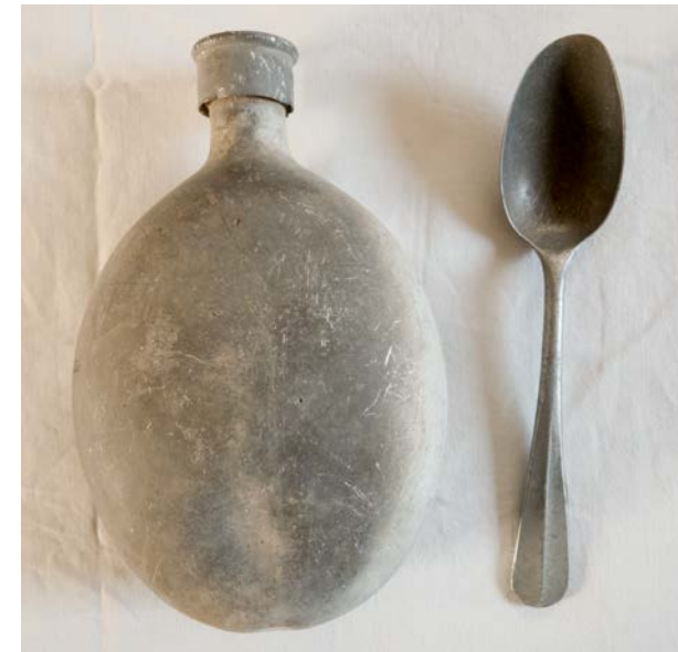
Obr. 17 Hliníková láhev (čutora) na vodu, II. světová válka, Německo (zn. W.A.L. 39), soukromá sbírka. Povrch jeví známky napadení kovu korozí způsobenou přítomností chloridů a síranů (půdní nález), který tento způsob degradace hliníku výrazně urychluje.
