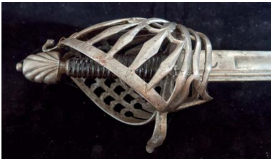
Obr. 84 Schiavona, 2. pol. 18. stol., severní Itálie, soukromá sbírka. Koš zbraně vyroben kovářskou technikou svařování v ohni, na povrchu známky lokálně ohraničené koroze způsobené vlivem běžné vlhkosti prostředí.
