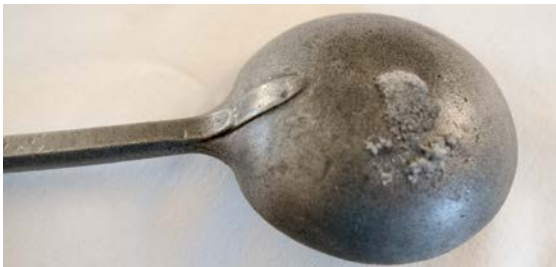
Obr. 101 Svatební lžíce, pol. 19. stol., Rakousko, soukromá sbírka. Ukázka napadení tzv. cínovým morem, který způsobuje postupný rozpad předmětu. Struktura materiálu nese známky bílých výrůstků – výtrusů v podobě bílého rozpadajícího se prášku.
