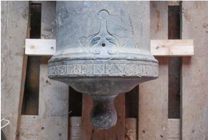
Obr. 6 Moždíř, konec 18. stol., Francie, soukromá sbírka. Vystupující nápis označující výrobce s datací (J. Beringer 1789) vznikl při odlévání metodou ztraceného vosku, reliéf na hlavní zhotoven ručně rytím.
