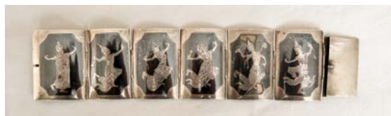
Obr. 107 Stříbrný náramek, 30. l. 20. stol., Thajsko, soukromá sbírka. Ukázka degradace části výzdoby techniky niello, mechanickým poškozením, způsobená nejspíše technologickou vadou a špatným přichycením hmoty niela ke stříbrnému podkladu.
