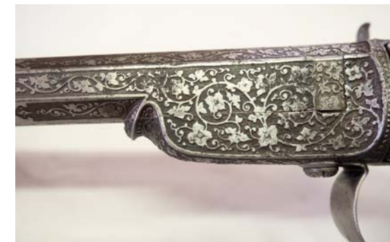
Obr. 73 Pistole na zápalky (pro pokojovou střelbu), 2. pol. 19. stol. Francie – Paříž (Henry Gordier), soukromá sbírka. Výzdoba provedena hlubokým leptem do ocelového povrchu.
