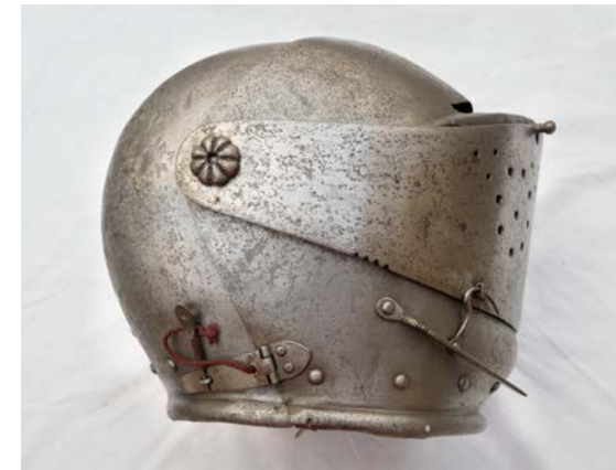
Obr. 90 Jezdecká přilba, 2. pol. 16. stol., Německo, soukromá sbírka. Povrch degradován dlouhodobým uložením ve vlhkém prostředí, jež způsobilo zasažení svrchních vrstev kovu důlkovou korozí. K jejímu odstranění byla použita v současnosti již nedoporučované ošetření odrezovačem ve složení kyseliny fosforečné.
