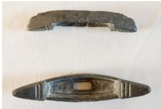
Obr. 105 Příčky pobočního německého kordíku, II. světová válka, Německo, soukromá sbírka. Povrch zinkového materiálu vykazuje hluboké napadení korozí (tzv. zinkový mor). Degradace je nepřímo podporována problematickým osazením zinkové příčky na ocelový řap čepele, kde tak vzniká tzv. galvanický článek. Pohledově je degradace patrná na povrchu zinku bílými mapami až krustami rozkladu, zasahující vnitřní strukturu hmoty kovu.
