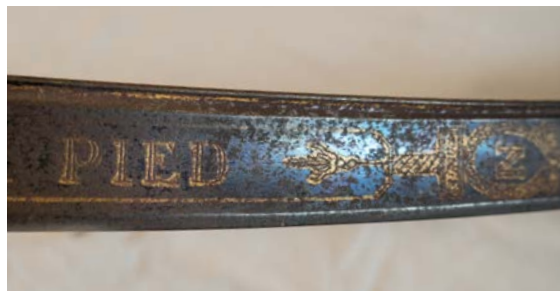
Obr. 108/Obr. 109 Důstojnická šavle Grenadiere (Císařská garda), 1809, Francie – Paříž, soukromá sbírka. Ukázka devastace způsobená podreznutím základního materiálu čepele s oceli na povrchovou úpravu ze zlacení a modření. Postupující koroze degraduje nejen samotný základní materiál z oceli, ale i povrchovou úpravu šavle, vytvořenou metodou chemického zlacení a modření. Zlato se jeho působením postupně ze základního materiálu odlupuje.
