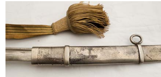
Obr. 92 Důstojnická šavle vz. 1904, Rakousko, soukromá sbírka. Čepel, koš a pochva poniklovány jakožto dobový způsob ochrany kovu proti korozi. V důsledku dlouhodobého uložení ve vlhkém prostředí jsou přesto na pochvě a čepeli patrné známky podrezení ploch coby devastace jádra kovu (ocel) i svrchního niklu.
