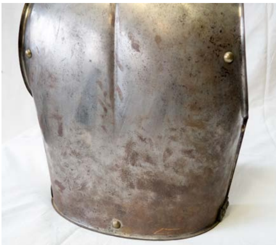
Obr. 88 Záda francouzského kyrsu vz. 1828, po-napoleonská doba, soukromá sbírka. Ukázka viditelných známek devastace povrchu kovu způsobené dotykem rukou, stav před konzervací.
