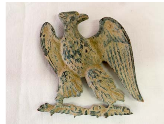
Obr. 99 Bronzový odlitek orla určený na čelní stranu husarské brašny, Francie, kolem roku 1800, soukromá sbírka. Ukázka degradace povrchu materiálu působením sirných složek v půdě.
