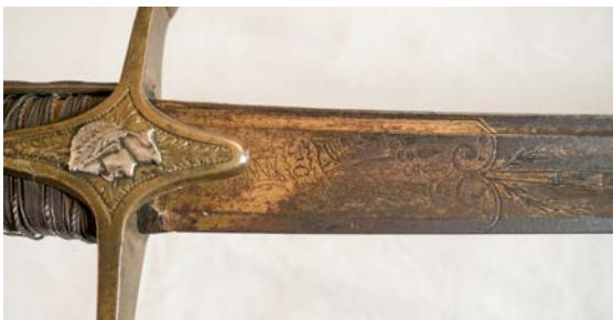
Obr. 108/Obr. 109 Důstojnická šavle Grenadiere (Císařská garda), 1809, Francie – Paříž, soukromá sbírka. Ukázka devastace způsobená podreznutím základního materiálu čepele s oceli na povrchovou úpravu ze zlacení a modření. Postupující koroze degraduje nejen samotný základní materiál z oceli, ale i povrchovou úpravu šavle, vytvořenou metodou chemického zlacení a modření. Zlato se jeho působením postupně ze základního materiálu odlupuje.
