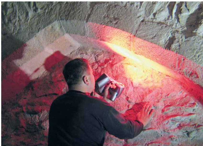
Obr. 14: Jednou z možností přesného zaměření architektonických prvků je 3D skenování. Menší prvky a detaily lze nejpodrobněji skenovat ručními skenery (Lipnice nad Sázavou – okres Havlíčkův Brod, hrad; foto F. R. Václavík, 2011).
